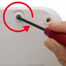
+ドライバーを使って電池ボックスのネジを左に回して開けます。
